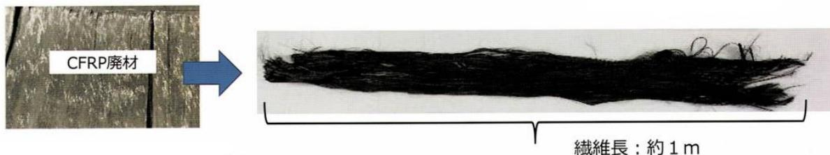
図8 CFRP から取り出された炭素繊維
